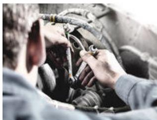
La double fourche Joker se prête idéalement au (contre-)serrage de vis et d'écrous.
