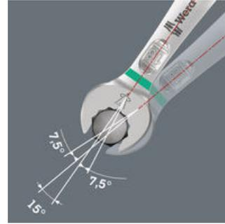
L'angle de 7,5° de la fourche, la géométrie 12 pans et l'ajustement de l'utilisation (positionner, visser, tourner, positionner, visser, tourner, etc.) permettent de visser même dans des situations où l'angle de reprise est inférieur à 30°.
