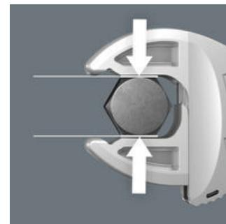
Les mors parallèles lisses de la Joker 7870 exercent une pression de surface et empêchent ainsi l'arrondissement de l'écrou ou de la tête de la vis susceptible de se produire lorsque la force est transmise par les angles.
