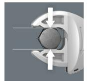
Les mors parallèles lisses de la Joker 7880 exercent une pression de surface et empêchent ainsi l'arrondissement de l'écrou ou de la tête de la vis susceptible de se produire lorsque la force est transmise par les angles.
