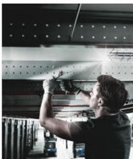
Avec Joker, vous pouvez désormais desserrer, contre-serrer et retirer vis et écrous dans des situations où les outils classiques échouent. La conjugaison de la butée et du faible angle de reprise permet un travail efficace, y compris sur les raccords vissés.
