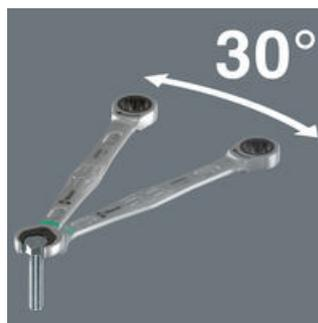
Au lieu des 60°, Joker offre un angle de reprise de 30° couplé à une géométrie 12 pans. Ce qui, en conjugaison avec sa tête droite, rend superflue l'inversion de la clé. Avec Joker, vous pouvez désormais desserrer, contre-serrer et retirer vis et écrous dans des situations où les outils classiques échouent. La conjugaison de la butée et du faible angle de reprise permet un travail efficace, y compris sur les raccords vissés.
