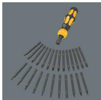
L'admission d'embout robuste convient aux embouts à emmanchement hexagonal 1/4" selon DIN ISO 1173-C 6,3 et E 6,3. Le système de lames interchangeables signifie pour l'utilisateur un poids et un encombrement réduits ainsi qu'une flexibilité élevée.
