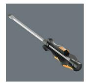
Avec une lame hexagonale traversante réalisée dans le même matériau haut de gamme que les embouts - d'où une transmission de force sans déperdition même lors de frappes au marteau. Le matériau à finition extra-rigide empêche l'éclatement ou la rupture de la lame.
