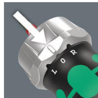
Mécanisme de cliquet à denture fine pour un angle de reprise faible. La bague d'inversion permet de changer le sens de vissage (droit, fixe, gauche). Le porte-embout magnétique convient aux embouts hexagonaux 1/4" selon DIN ISO 1173-C 6,3 et de la série Wera 1.
