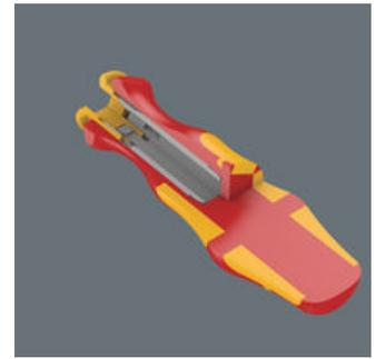
Le porte-embouts est réservé aux lames interchangeables VDE Wera. Manche Kraftform Plus favorisant l'ergonomie au travail et empêchant la formation d'ampoules et de callosités. Les zones dures permettent une vitesse de travail élevée alors que les zones tendres garantissent la transmission de couples élevés.
