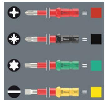
Les lames interchangeables Kraftform Kompakt VDE sont munies du système de repérage d'outils Take it easy. Le code couleur en fonction des empreintes et l'indication de la taille gravée au laser permettent de trouver rapidement et facilement l'outil nécessaire.
