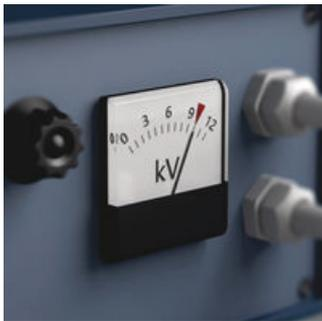
Le contrôle de la rigidité diélectrique de l'outil à 10 000 volts donne à l'utilisateur la tranquillité d'esprit que la propriété la plus importante de son outil, à savoir l'isolation, a été testée. Les outils VDE Wera sont contrôlés pièce à pièce. La sécurité du travail jusqu'à 1 000 volts est ainsi garantie.
