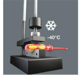
Le contrôle de la résistance au choc à froid (à -40° C) garantit la sécurité même dans les conditions d'utilisation extrêmes.
