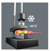
Le contrôle de la résistance au choc à froid (à -40° C) garantit la sécurité même dans les conditions d'utilisation extrêmes.
