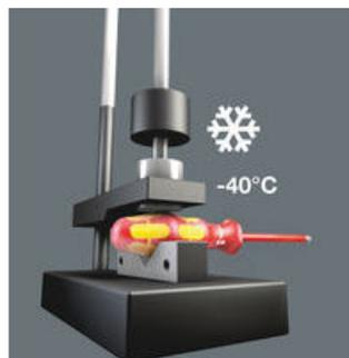
Le contrôle de la résistance au choc à froid (à -40° C) garantit la sécurité même dans les conditions d'utilisation extrêmes.
