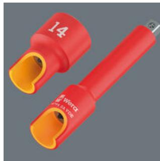
Les douilles et rallonges Zyklop pour électriciens offrent une sécurité accrue grâce à leur isolation bicomposant avec un cœur isolant jaune et une couche isolante externe rouge.
