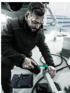
La denture fine à 80 dents du cliquet Zyklop Comfort permet un faible angle de reprise de seulement 4,5°.
