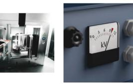
Le contrôle unitaire sous 10 000 volts conformément à la norme IEC 60900 garantit un travail en toute sécurité jusqu'à 1 000 volts.
