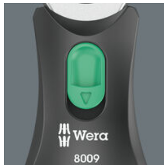
Grâce au bouton coulissant positionné sur les deux côtés, la tête du cliquet peut être verrouillée dans les positions définies 0°, 15° et 90° à droite et à gauche.
