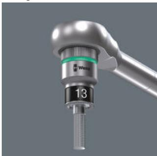
Le maintien de la vis hexagonale dans la douille à carré est assuré par deux billes élastiques et une gaine thermorétractable haute résistance à élasticité permanente. Celle-ci est protégée contre les endommagements mécaniques par une collerette d'acier située à l'avant. Particulièrement utile dans les espaces de travail d'accès difficile, où l'on ne peut pas se servir de l'autre main pour maintenir la vis.
