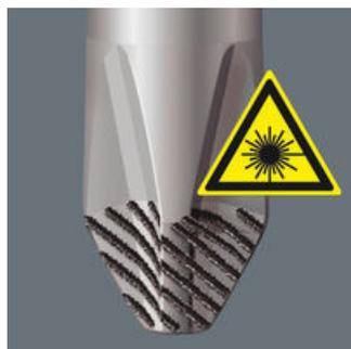
À l'aide d'un laser extrêmement concentré, on génère une structure superficielle acérée. Wera Lasertip s'agrippe dans la tête de vis et empêche le dérapage hors de celle-ci. Pour vis à fente, Phillips et Pozidriv.
