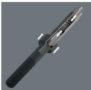
Les embouts 4-en-1 9506 et 9507 sont compatibles avec quatre tailles de vis. Avec l'embout 4-en-1 9506 quatre tailles de vis à six pans creux (3,0 ; 4,0 ; 5,0 ; 6,0), avec l'embout 4-en-1 9507 trois tailles de vis à six pans creux (2,5 ; 5,0 ; 6,0) et une taille de vis TORX® (TX 25). Pour utiliser le profil supérieur, il faut appuyer en continu contre le ressort en vissant, de manière à enfoncer le profil plus petit.
