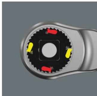
Double denture. Confère aux 38 robustes dents de scie l'effet de précision mécanique d'une fine denture de 76 à angle de reprise de 4,7°.
