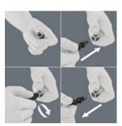
Outil en matière plastique (TPE) pour le retrait simple des écrous retenus dans les douilles avec fonction de retenue.
