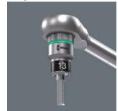
Le maintien de la vis hexagonale dans la douille à carré est assuré par deux billes élastiques et une gaine thermorétractable haute résistance à élasticité permanente. Celle-ci est protégée contre les endommagements mécaniques par une collerette d'acier située à l'avant. Particulièrement utile dans les espaces de travail d'accès difficile, où l'on ne peut pas se servir de l'autre main pour maintenir la vis.
