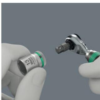
L'adaptateur 870/1 (hexagonal 1/4" vers carré 1/4") permet aussi d'utiliser des douilles et douilles-embouts 1/4" avec le cliquet à embout 8011 Zyklop Mini 4.
