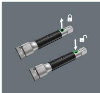
Les rallonges des séries haut de gamme sont par ailleurs équipées du système "flexible-lock". Son activation permet de fixer aussi longtemps que nécessaire les douilles sur la rallonge. L'outil ne peut plus être égaré ou tomber. Lorsque le système est désactivé, les douilles peuvent être emboîtées et échangées très rapidement.
