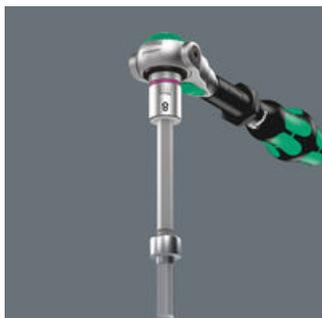
Le serrage de la vis à six pans creux sur la douille-embouts est assuré par une bille élastique en contact avec l'embout. Particulièrement utile dans les espaces de travail d'accès difficile, où l'on ne peut pas se servir de l'autre main pour maintenir la vis.
