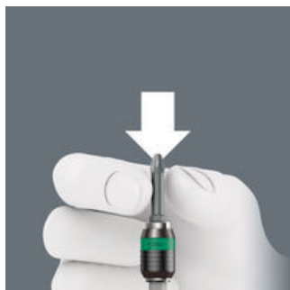
Bits-kärki voidaan lukita kiinni koskematta lukitusrenkaaseen toisella kädellä. Heti kun bits-kärki on asetettu ruuviin, lukitus aktivoituu automaattisesti. Bits-kärki istuu turvallisesti ja vaappumatta.
