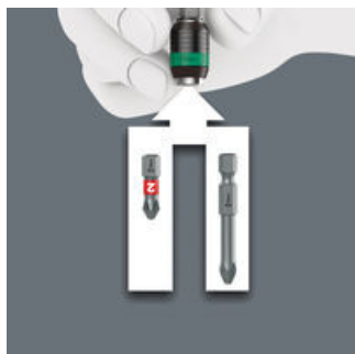
Rapidaptor-pikavaihtopitimeen voidaan kiinnittää sekä 1/4"-bits-kärkiä standardin DIN ISO 1173-C 6,3 ja E 6,3 mukaisesti sekä Wera liitäntäsarjojen 1 ja 4 bits-kärkiä.
