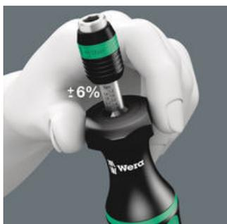
La exactitud de medición está en  $\pm 6\%$  (artículo 1430:  $\pm 10\%$ ) según la norma DIN EN ISO 6789. Se oye y se palpa claramente el "clic" tan pronto se alcanza el par de apriete ajustado.
