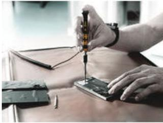
Al realizar trabajos de atornillado en componentes electrónicos (como por ejemplo, en teléfonos móviles o tabletas) tiene que evitarse que se produzcan descargas electrostáticas ya que esto puede causar malfunciones, o, en el peor de los casos, la avería total del aparato electrónico. Por eso es indispensable utilizar herramientas de atornillar que estén aseguradas electrostáticamente.
