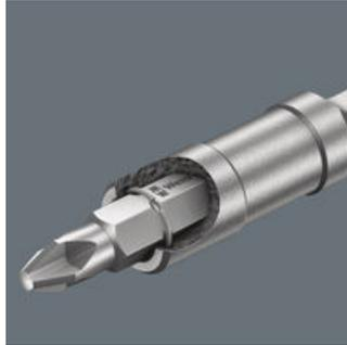
Con anillo de retención (S = extra fuerte) y un potente imán permanente para un posicionamiento de la punta especialmente seguro dentro del porta-puntas.
