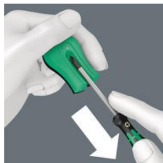
Con ayuda del magnetizador Wera: Simplemente pase la herramienta por el lado positivo del magnetizador Wera, y la herramienta inmediatamente sostiene el tornillo de manera segura en su varilla.
