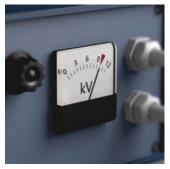
La prueba en un 100 % de las herramientas a 10.000 voltios según IEC 60900 garantiza un trabajo seguro bajo una tensión hasta 1.000 voltios.
