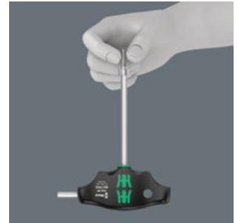
El aprisionamiento del tornillo hexagonal interior en el extremo de la herramienta se garantiza por medio de una bola elástica. Esto es especialmente útil en aquellos casos en los cuales se trabaja en entornos de montaje de acceso difícil donde no es posible utilizar la otra mano para sostener el tornillo.
