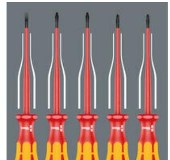
El diámetro reducido de la varilla con aislamiento de protección integrado permite un mejor acceso, lo que facilita trabajos en elementos de uniones atornilladas y muelles que se encuentran en posiciones profundas; testado de forma individual según IEC 60900.
