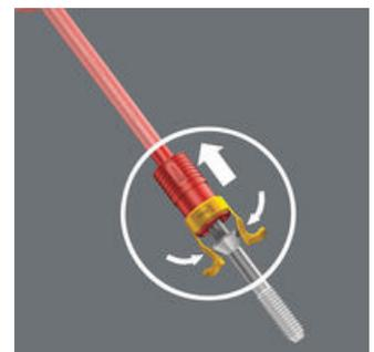
Ahora siga desplazando toda la garra un poco más en dirección del mango del destornillador hasta que los dos brazos del sujeta-tornillos queden acoplados a la cabeza del tornillo y estén levemente tensionados hacia afuera.
