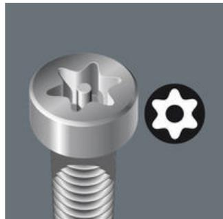
Ha sido construido para evitar que las así llamadas uniones atornilladas de seguridad se desmonten sin autorización. Para que no sea posible la utilización prohibida de herramientas TORX® comunes, los tornillos, en su perfil de arrastre disponen de un pivote. Este pivote se aloja dentro del taladro de las herramientas TORX® B0, y así sí es posible aflojar la unión de seguridad.
