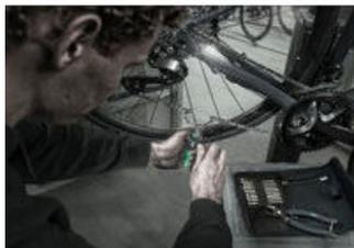
Con tronchacadenas y soportacadenas y con el perno de remache intercambiable, para abrir y cerrar cadenas de bicicleta. Adecuado para cadenas Single-Speed de hasta 12 velocidades
