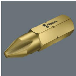
Puntas A son puntas para el área aeronáutica. Se trata de puntas especialmente duras con un perfil afilado que es capaz de romper, por ejemplo, las capas de laca o de pintura que pudieran haber penetrado en los perfiles de tornillos; de esta forma se garantiza una transmisión de fuerza segura entre punta y tornillo.
