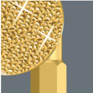
Las partículas minúsculas de diamante que han sido aplicadas en el extremo de la punta, durante el proceso de atornillado se aferran fuertemente al tornillo y permiten un alojamiento exacto y seguro contra el deslizamiento, dentro de la cabeza del tornillo. Este alojamiento seguro sirve para proteger el tornillo, ya que permite una importante reducción de las fuerzas de expulsión, que normalmente obligan al usuario a ejercer una presión muy alta en el tornillo.
