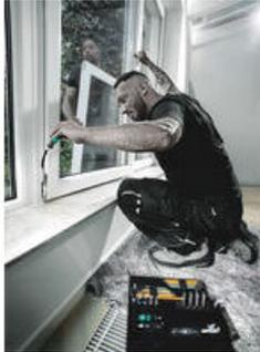
Con el destornillador 393 S también es posible atornillar detrás de las esquinas. Gracias a su vástago flexible, este destornillador permite acceder a tornillos de fijación que estén situados en lugares complicados. Este útil es la herramienta ideal en aquellas situaciones en las cuales es difícil alcanzar el tornillo
