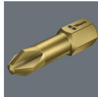
Puntas TH son puntas duras con zona de torsión. Las puntas de torsión amortiguan los picos del par de giro en la zona de torsión. Así se evita un desgaste prematuro, y se aumenta la longevidad de la punta.
