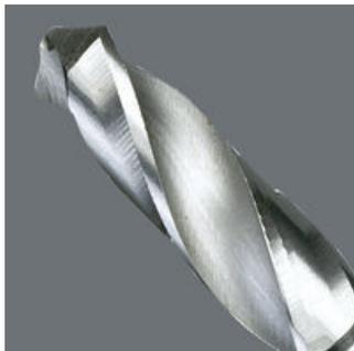
Punta de brocas helicoidales - para aplicaciones de metal<ul><li>Arrastre de 1/4" adecuado para porta-puntas según norma DIN 3126-D 6,3</li><li>Transmisión de fuerza sin pérdidas gracias al vástago hexagonal</li><li>HSS = acero de corte ultrarrápido</li><li>Elasticidad finamente graduada para una larga vida útil</li><li>Excelente precisión de concentricidad</li><li>Puntas extra-tenaces bonificadas para una vida útil especialmente larga</li></ul>
