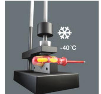
Incluso bajo condiciones extremas de servicio se garantiza la seguridad, gracias a las pruebas de resistencia a impactos a baja temperatura de hasta 40°C bajo cero.
