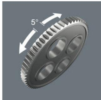
La llave dinamométrica Safe-Torque dispone de un dentado fino de 72 dientes y tiene un ángulo de retorno de tan solo 5°. Esta carrera tan pequeña permite un trabajo rápido y preciso en cualquier situación de montaje.
