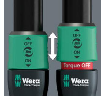
La función dinamométrica puede desactivarse, y así la herramienta también es utilizable para soltar tornillos y tuercas.
