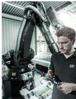
Llave dinamométrica Click-Torque Lock con función Torque Lock. Facilita el trabajo con par de apriete.
