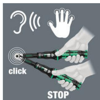
Al alcanzar el valor dinamométrico preajustado, se escucha y se palpa un mecanismo de salto.
