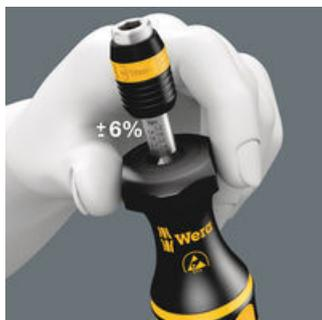
La exactitud de medici­o­n est­a en  $\pm 6\%$  (art­iculo 1430:  $\pm 10\%$ ) seg­un la norma DIN EN ISO 6789. Se oye y se palpa claramente el "clic" tan pronto se alcanza el par de apriete ajustado.
