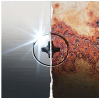
Por medio de la utilización de puntas de acero inoxidable se previene la formación de óxido en tornillos o superficies de acero inoxidable. La contaminación en el acero inoxidable, ante todo se forma por la abrasión al realizar trabajos de atornillado con herramientas convencionales de acero. La abrasión produce partículas de acero fuertemente adherentes que bajo el efecto de oxígeno se convierten en óxido.
