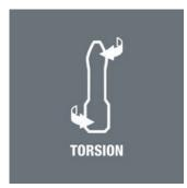
Las puntas de torsión (T) amortiguan los picos del par de giro en la zona de torsión. Así se evita un desgaste prematuro, y se aumenta la longevidad de la punta.
